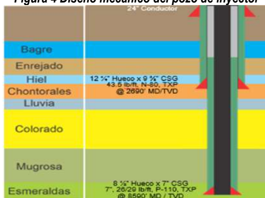
Figura 4 Diseño mecánico del pozo de inyector
